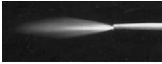
รูปที่ 3.21 แสดงลักษณะของเปลวออกซิไดซ์
