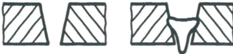
รูปที่ 9.25 แสดงการหลอมละลายไม่สมบูรณ์
