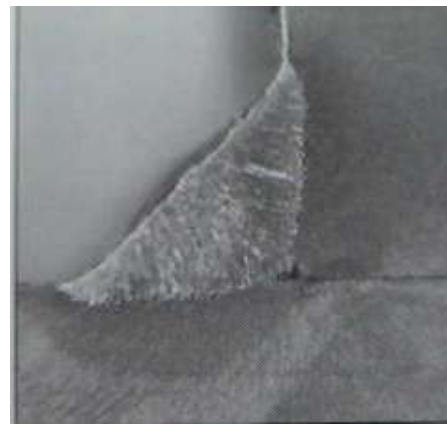
รูปที่ 9.14 แสดงก๊าซปกคลุมแบบ มิก/แม็กและรูปเชื่อม
