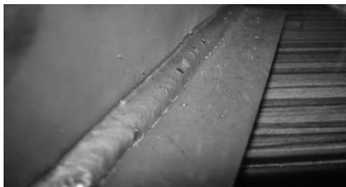
รูปที่ 9.17 แสดงแนวเชื่อมที่ได้จากแก๊สอาร์กอนผสมแก๊สคาร์บอนไดออกไซด์
