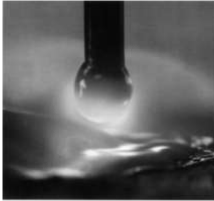
รูปที่ 9.12 แสดงการถ่ายเทโลหะแบบ Globular Transfer
