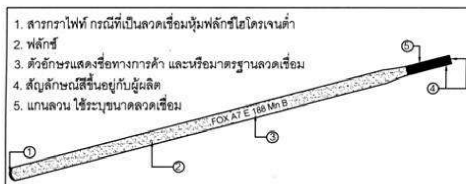
รูปที่ 5.2 แสดงสัญลักษณ์บนลวดเชื่อม
