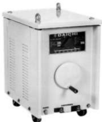
รูปที่ 2.10 แสดงลักษณะของเครื่องเชื่อมกระแสสลับ
