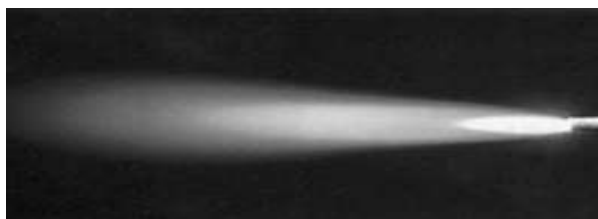
รูปที่ 3.19 แสดงลักษณะของเปลวไฟคาร์บูไรซิง
