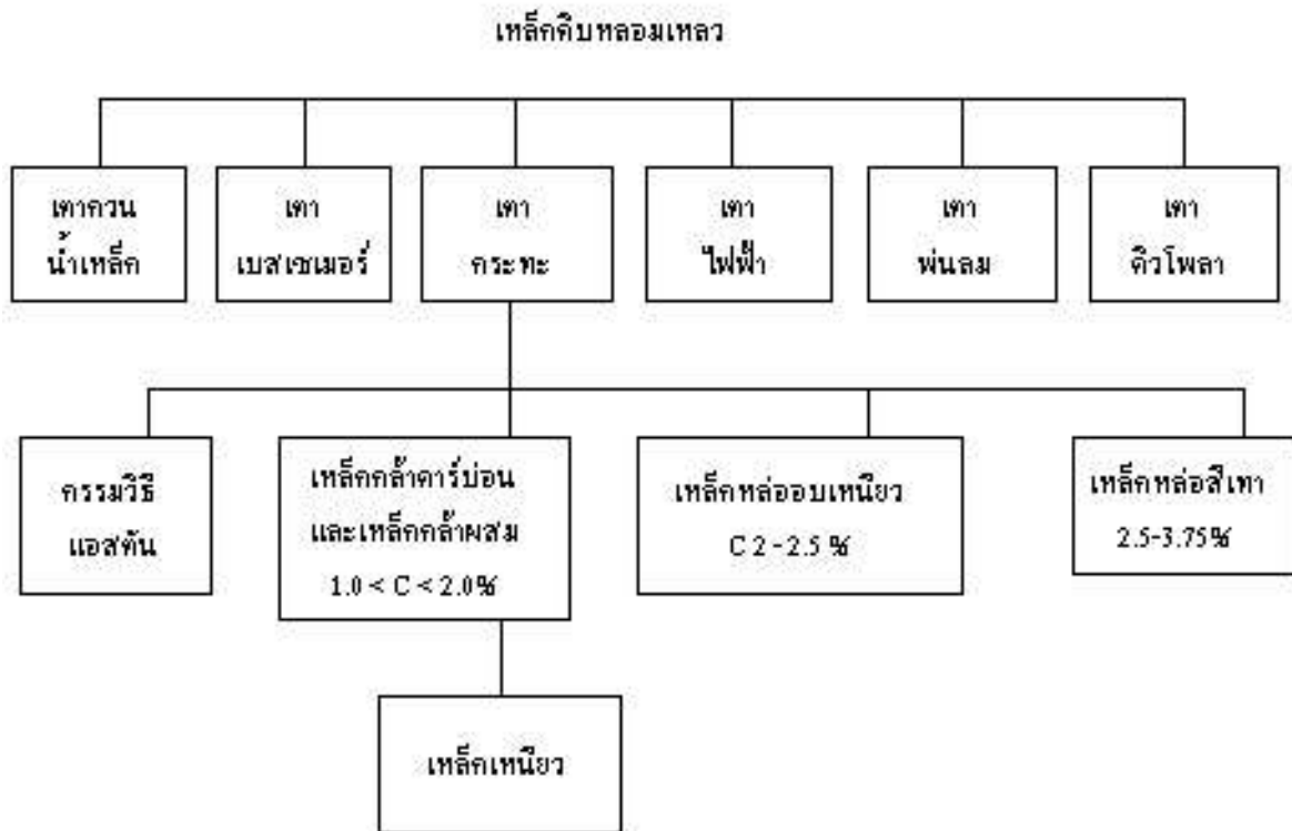
ขั้นตอนการผลิตเหล็กชนิดต่างๆจากเหล็กคืบ
