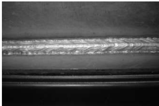
รูปที่ 9.15 แสดงแนวเชื่อมที่ได้จากแก๊สอาร์กอน
