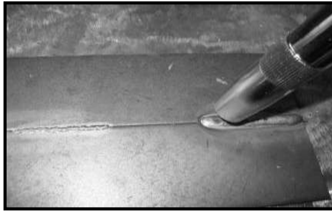
รูปที่ 9.8 แสดงการเชื่อมแบบ Fore hand
