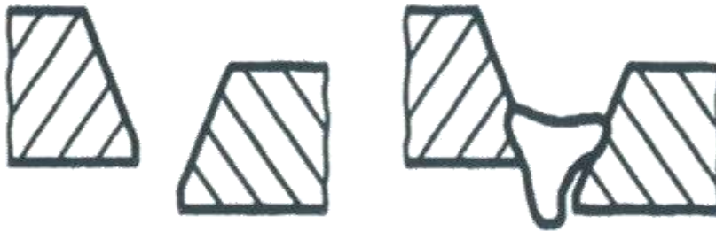
รูปที่ 9.27 แสดงการหลอมละลายไม่สมบูรณ์
