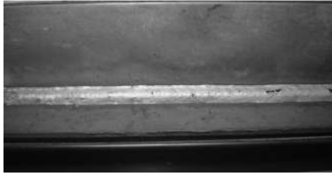
รูปที่ 9.18 แสดงแก๊สอาร์กอน+ แก๊สคาร์บอนไดออกไซด์+ แก๊สออกซิเจน
