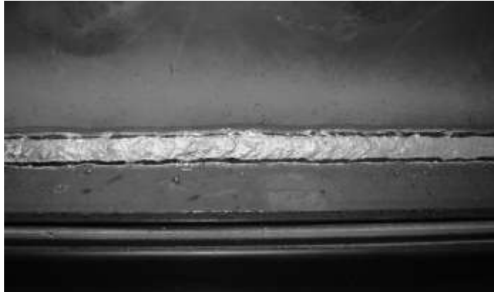
รูปที่ 9.16 แสดงแนวเชื่อมที่ได้จากแก๊สคาร์บอนไดออกไซด์
