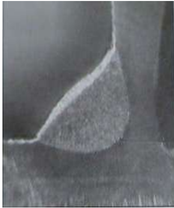
รูปที่ 9.14 แสดงก๊าซปกคลุมแบบ มิก/แม็กและรูปเชื่อม
